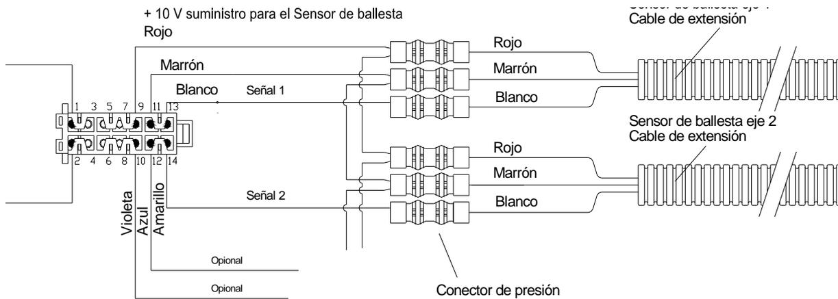
**Instalación Eléctrica de Sensor SG en ejes dobles**
