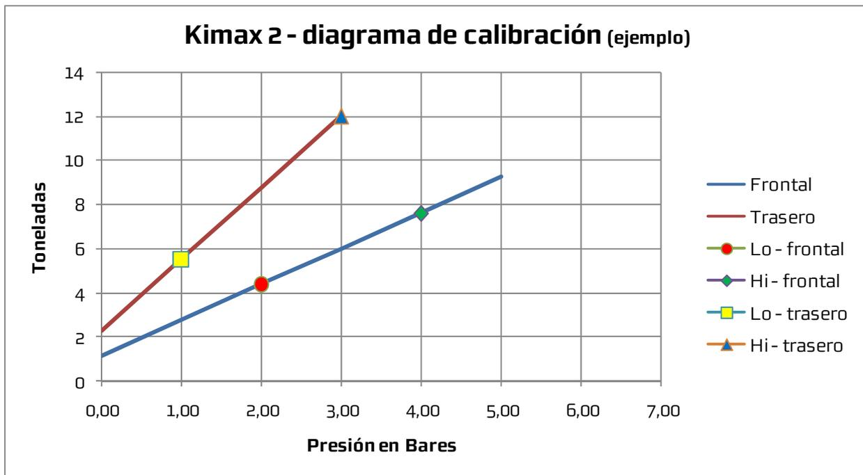
La presión de aire se mide en el lado derecho e izquierdo de cada eje y se envía al instrumento Kimax para obtener la máxima precisión en los resultados de pesaje en diferentes circunstancias.
