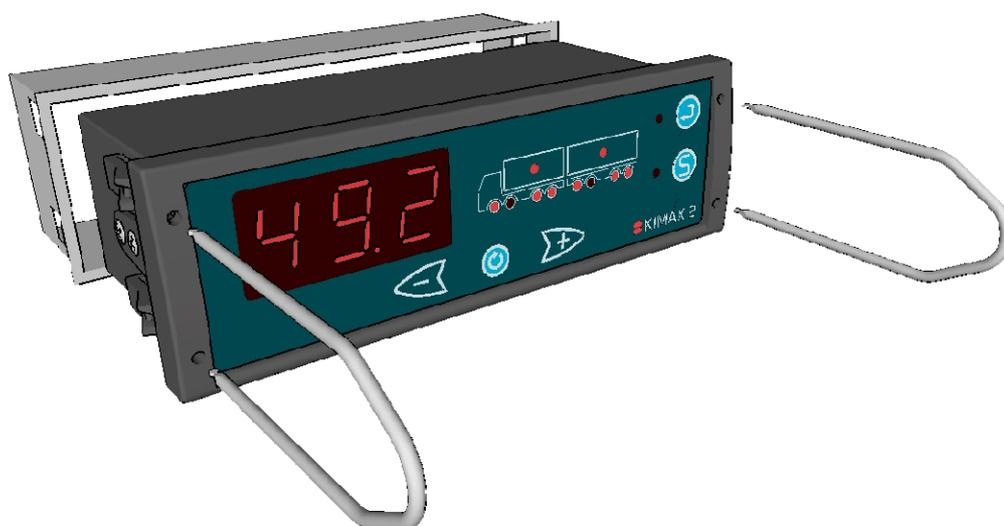
Para sustituir el Kimax 2 radio debe utilizar las dos horquillas correspondientes para soltar las piezas de encaje antes de sacar el instrumento del marco.
