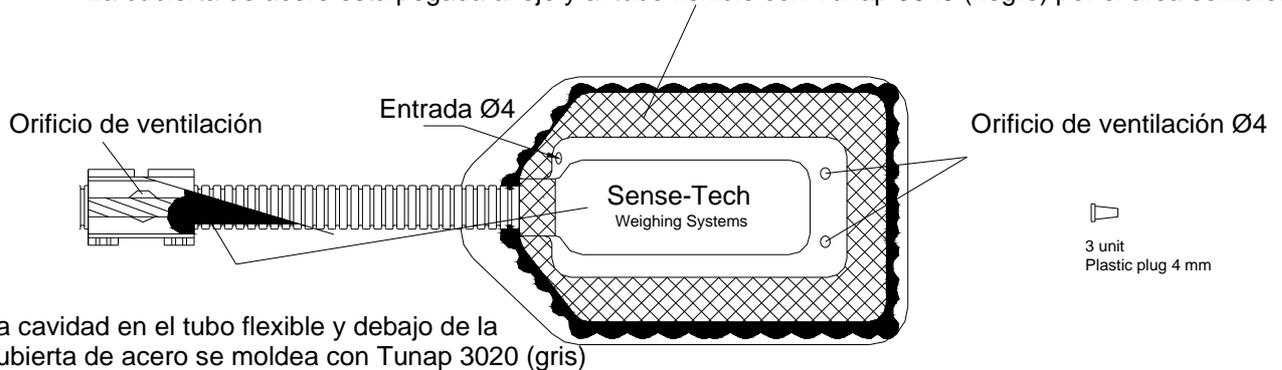
La cavidad en el tubo flexible y debajo de la cubierta de acero se moldea con Tunap 3020 (gris)
