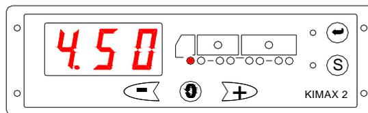
Si pulsa el botón + una vez, el LED del eje pasará al siguiente eje activo de la derecha. En este caso, se enciende el LED del eje #2 y aparece la lectura real del peso del eje #2.
