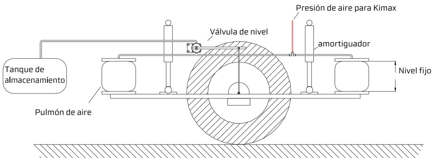
Para poder utilizar correctamente la báscula a bordo, los ejes deben calibrarse después de la instalación. La calibración se realiza pesando cada eje del vehículo en una báscula fija. Mientras su camión se encuentre en la báscula fija debe introducir el peso en vacío (Lo) y el peso con carga (Hi) con el vehículo vacío y cargado respectivamente.
