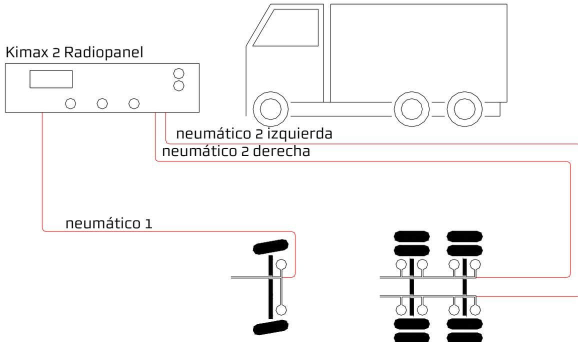
Si su eje elevador se ha accionado, la presión en aire 3 izquierda equivale a aire 2 izquierda y la presión en aire 3 derecha equivale a aire 2 derecha; los ejes 2 y 3 comparten el peso de la parte posterior de su vehículo.
