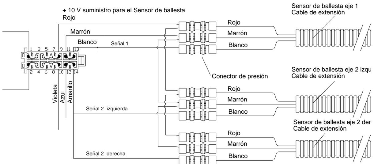
**Instalación Eléctrica de Sensor SG en eje frontal individual y doble eje trasero**
