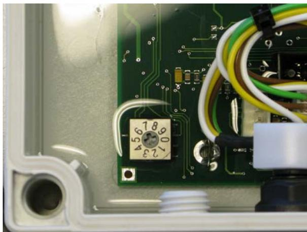
Si utiliza el Kimax 2 sensor como un instrumento Esclavo 1, la aplicación típica se haya en su camión junto con una pantalla en su cabina. El botón giratorio debe estar en la posición 1 para desbloquear la configuración y la calibración, y en la posición 3 para la posición de bloqueo.
