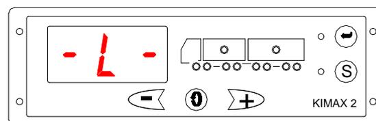
Con el botón de scroll y los botones de +/- puede visualizar el peso individual de cada eje, la carga que lleva y el peso total del vehículo.
