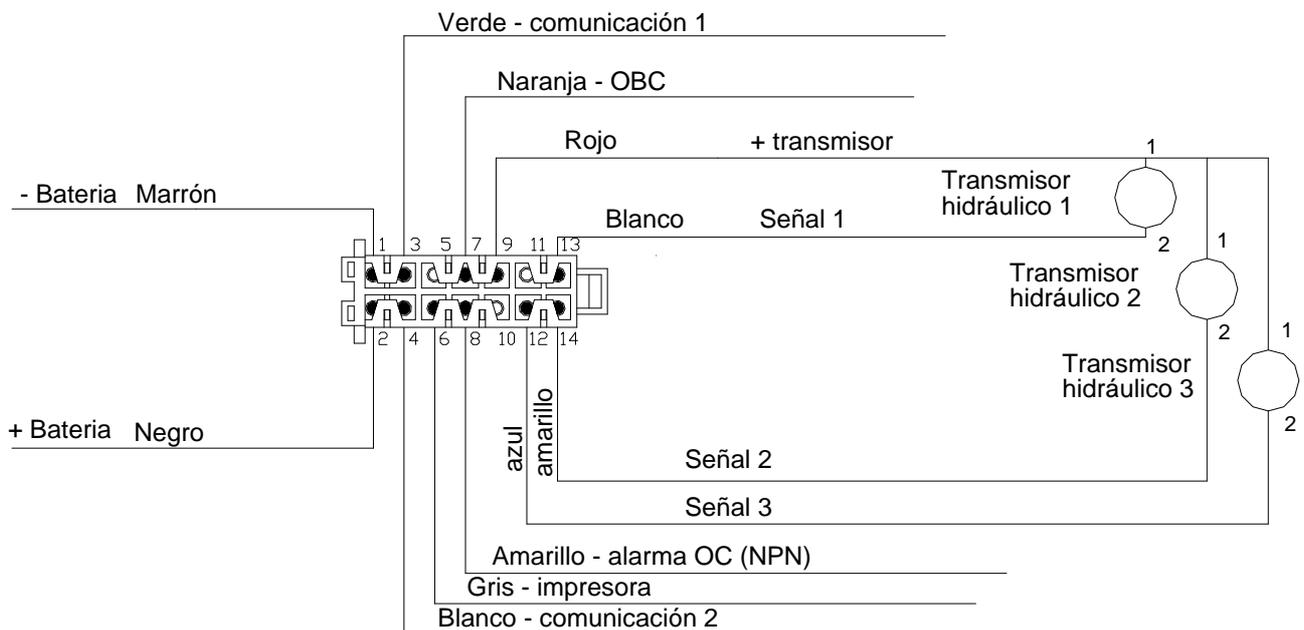
Si utiliza el Kimax 2 universal o el Kimax 2 sensor, cada unidad está equipada con un cable y el correspondiente conector, que encaja directamente con el sensor hidráulico.
