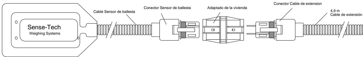
**Instalación Eléctrica de Sensor SG individual**
