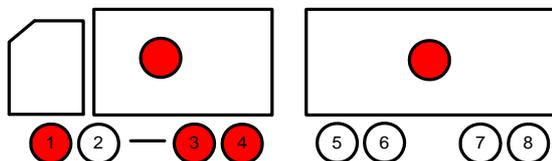
Entre en el submenú CF y pulse el botón de scroll hasta que en la pantalla se lea 4. El LED del eje 1 se encenderá. Pulse el botón + o - para que el LED del eje parpadee. Cuando el LED del eje parpadee podrá cambiar su configuración pulsando el botón S. En la pantalla del instrumento sólo aparecerá 4. Pulse + o - para que el primer LED de eje del rígido parpadee y pulse S para cambiar la configuración.
