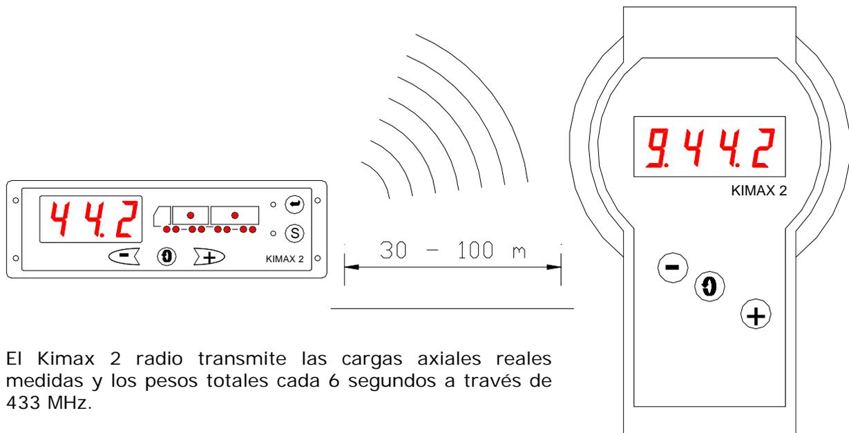
El Kimax 2 radio transmite las cargas axiales reales medidas y los pesos totales cada 6 segundos a través de 433 MHz.
