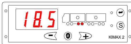
Si vuelve a pulsar el botón +, el LED del eje pasará al siguiente eje activo de la derecha; en este caso, el eje #5, que es el primer eje del rígido. En la pantalla aparecerá el peso correspondiente.
