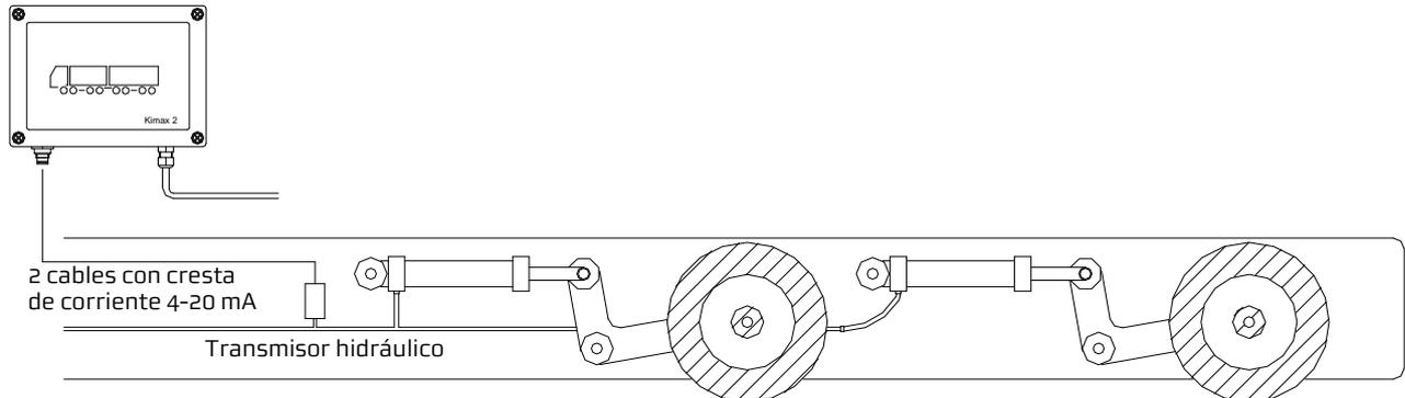
Si utiliza Kimax 2 radio para sensores hidráulicos, debe conectar el/los sensor(es) tal como se indica en el esquema de conexiones de abajo. El sensor hidráulico de 2 cables debe ser suministrado o bien por el suministro de Kimax 2 sensor (pin 9) o directamente de la red de suministro de 24 V.
