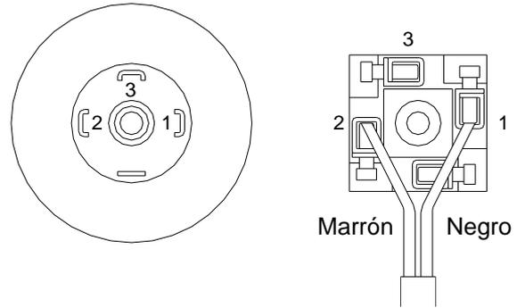
El sensor hidráulico actúa como sensor de cresta de corriente de 2 cables conectado al instrumento Kimax mediante un resistor a masa interno.
