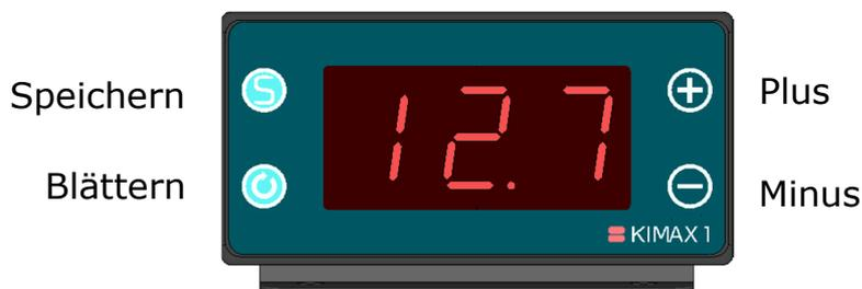
Beim Starten des Gerätes wird zunächst **tot** (Gesamtgewicht) angezeigt, und nach 1 Sekunde erscheint am Display der Ist-Gewichtswert des Fahrzeugs/der Achse/der Achsengruppe.
