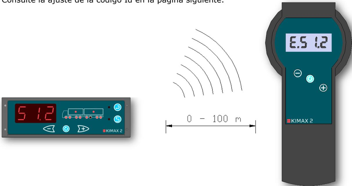
El Kimax 2 Radio/Universal transmite las cargas axiales reales medidas, carga útiles y los pesos totales cada 3 segundos a través de 433.92 MHz.
