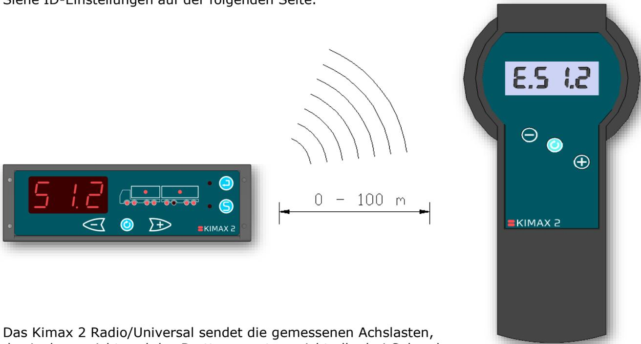
Das Kimax 2 Radio/Universal sendet die gemessenen Achslasten, das Ladegewicht und das Bruttogesamtgewicht alle drei Sekunden auf einer 433,92 MHz Funkverbindung aus.
