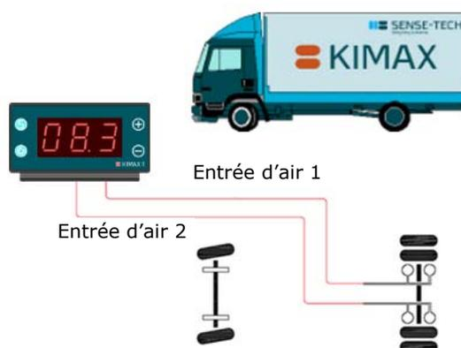
Le Kimax à double entrée d'air peut être appliqué sur des véhicules avec un ou plusieurs essieux munis de système pneumatique à plusieurs circuits d'air.
