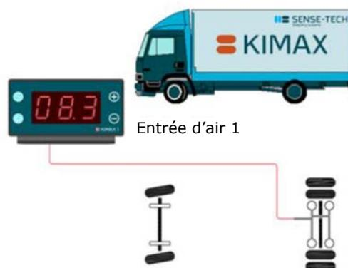
Un Kimax avec double entrée d'air est utilisé sur des véhicules avec contrôle de niveau séparé pour un ou deux essieux.
